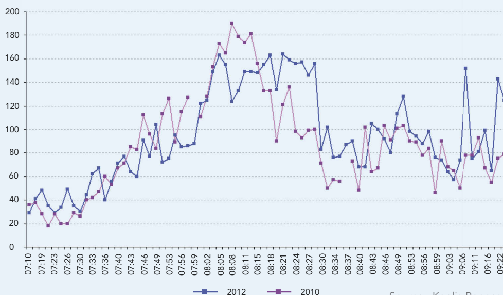
Comparaison de la charge de la rame à l'arrivée à la station de métro Pontchaillou : 2010 - 2012
