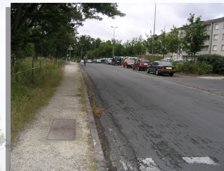
Rue Maurian – Voie de desserte locale Photo 01 - Trottoirs mal entretenus, sous dimensionnés - Usage de la voirie pour pratique piétonne - Pas d'aménagement cyclable. Vitesse limitée à 30km/h - Trafic routier faible
