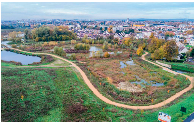
Zone d'expansion des crues et zones humides créées par renaturation d'un tronçon du Croult - © SIAH
