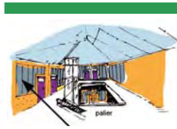
Système d'éclairage zénithal et en second jour offrant un apport de lumière complémentaire aux espaces
