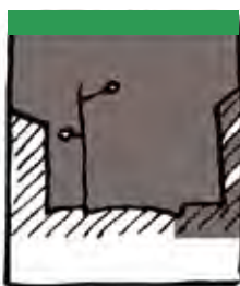
Éclairage chaussée plus trottoir
