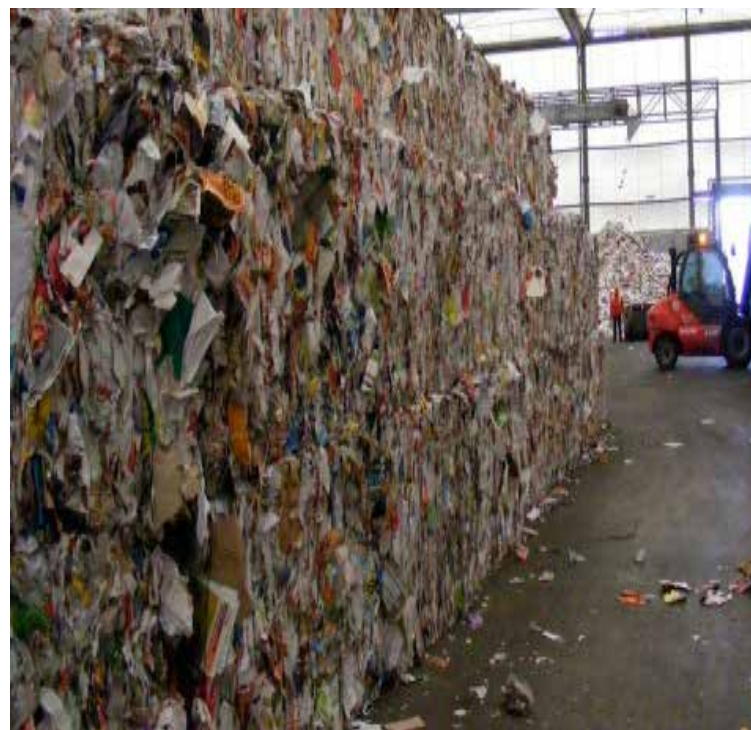
Usine de tri et d'incinération Astria, à Bordeaux - Compactage des papiers avant leur départ vers des usines de recyclage © SB - Rue89 Bordeaux
