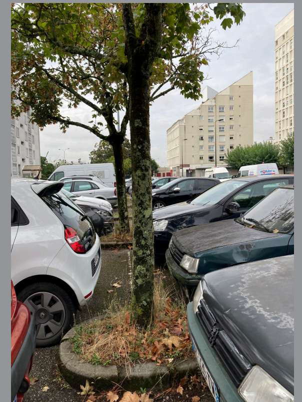
2 Fosses de plantations insuffisantes pour une bonne croissance des arbres et ne permettant pas de collecter les eaux de ruissellement
